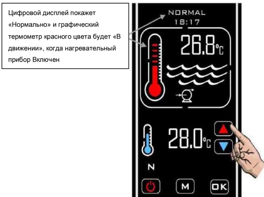
Фактическая температура воды бассейна показана в верхней части дисплея. Требуемая температура показана в нижней части дисплея. Требуемая температура воды может быть отрегулирована касанием клавиш ВВЕРХ/ВНИЗ, пока не появится требуемая температура, регулировка имеет ход  $\pm 0.1^\circ\text{C}$ .
