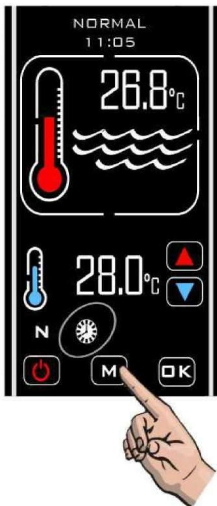
В этом режиме регулятор будет только нагревать во время периода установленного времени и при получении достаточного потока.
