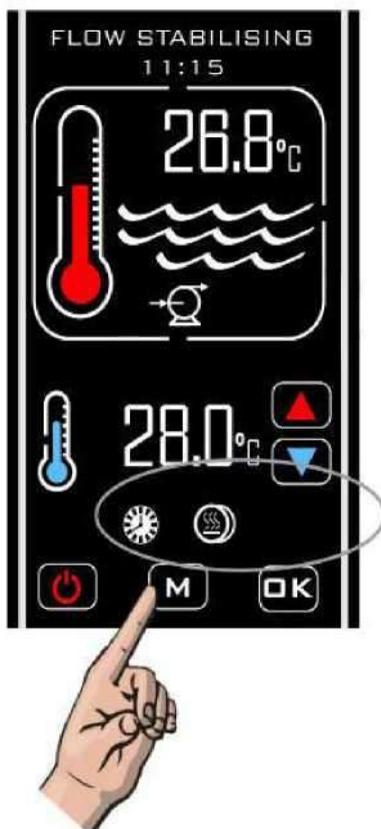
В этом режиме регулятор будет нагревать, когда он получает поток во время периода включенного времени и «Приоритет нагревания» будет выполняться, когда таймер «Выключен».
